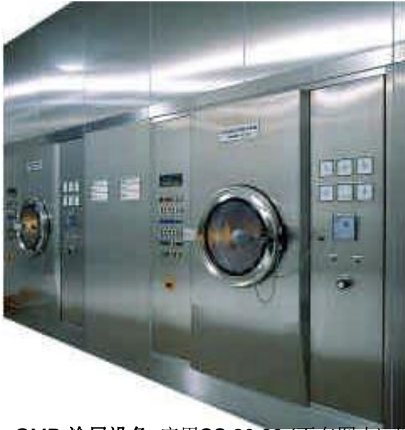
GMP-涂层设备 应用SS 20.60 (不在图中) 控制空气吸入流量
