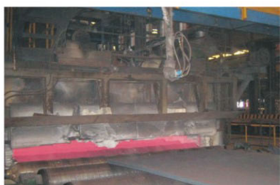
使用漫反射W45在炉前检测钢坯到位
