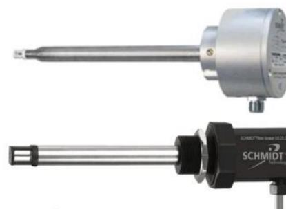
Schmidt流量计SS 20.650, SS 25.60 在工业窑炉监控领域中的应用，最大耐高温达 +350 °C，耐高压达16 bar，量程到200m/s，SS 25.60可测量氧气含量高达100%的介质。
