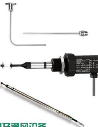
热锥型探头，Schmidt流量传感器SS 20.400, 23.400, 20.415量程范围0.05m/s 到20m/s，可判断流向，ATEX防爆版本，通过PC可以进行配置，安装简易、快捷，按GMP标准设计。
