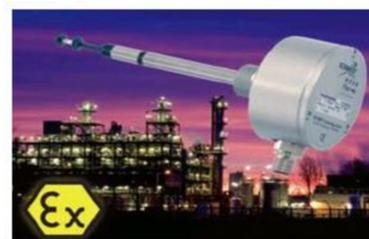
Schmidt流量传感器SS 20.500在生产工序中的应用。量程范围0.06m/s 到35m/s，带防爆认证ATEX Cat. 3，可选涂层针对腐蚀性气体，最大耐高压10bar，可选高精度校准，可同时测量温度。可应用于潮湿、粉尘、有污染的环境。
